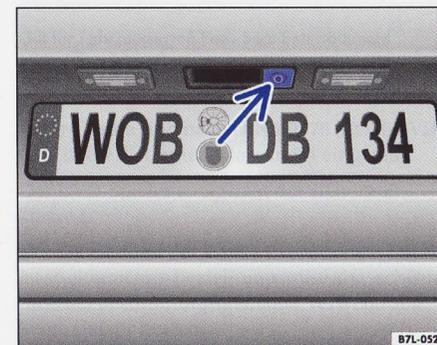
Abb. 9 Prinzipdarstellung: Einbauort der Rückfahrkamera
