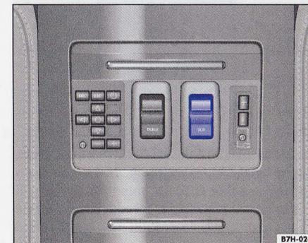
Abb. 10 Schalter zum Aus- und Einklappen des LCD-Monitors in der Mittelkonsole zwischen den hinteren Einzelsitzen.
