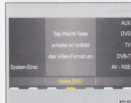
Abb. 15 Prinzipdarstellung des Navigationssystems RN S2 DVD mit dem Hauptmenü AUX.
