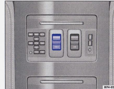
Abb. 7 Schalter zum Aus- und Einfahren des Klappstischs in der Mittelkonsole zwischen den hinteren Einzelsitzen.
