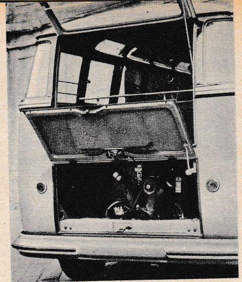
Der Kofferraum ist auch von hinten bequem zugänglich (obere Klappe) und verschließbar. Die untere Klappe dient dem Zugang zum Motor; auch sie ist absperribar.
